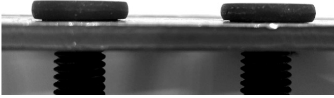
Şekil 5. Cıvataların sac metal panele çakıldıktan sonraki görüntüsü
