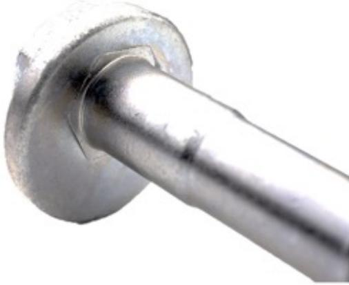
Şekil 3. Çakma prosesiyle üretilmiş kamber civatası numunesi.
