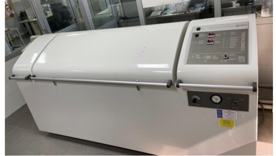
Şekil 5. Liebisch Model: 42016101 tuz püskürtme testi kabini.
