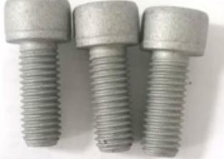
Şekil 9. Kaplama 2 uygulanmış yapılmış civataların tuz püskürtme testi sonucu.
