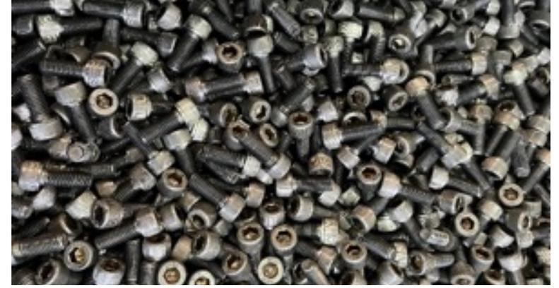
**Şekil 3.** Üretilmiş M10x25 DIN912 A2-70 paslanmaz test civataları.
