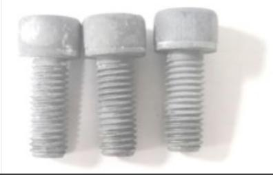
Şekil 8. Kaplama 1 uygulanmış civataların tuz püskürtme testi sonucu.
