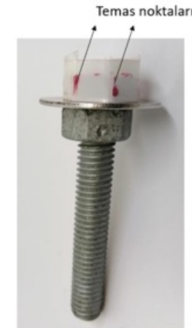
Şekil 1. M8x1,25 DIN 933 cıvata için torklama testi sonrası temas alanlarının belirlenmesi.
