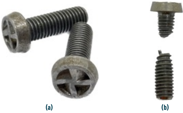
Şekil 8. NOW® ürünü (a) görseli (b) çekme testi sonrası dış dibinden kırılma
