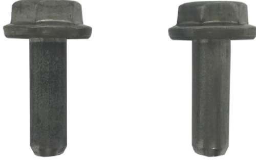
Şekil 8. Dövme hattından alınan ürün formu (a) Çinko-fosfat kaplı, (b) Polimer kaplı.
