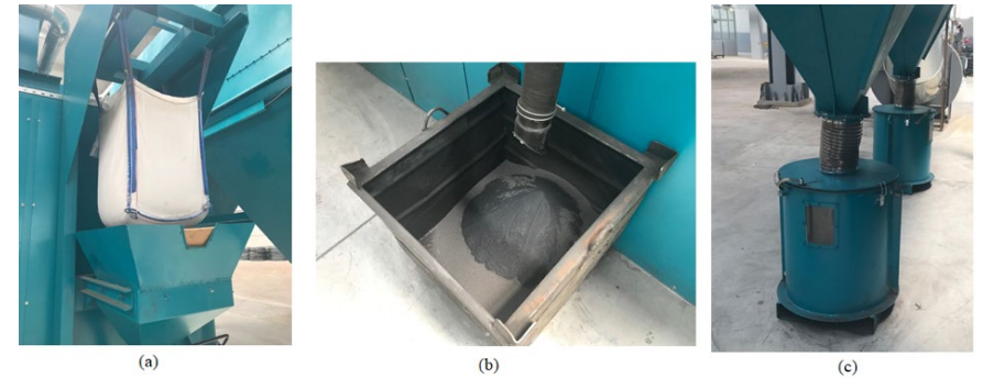
Şekil 7. (a) Kullanılmamış bilye yüklemesi, (b) Tekrar kullanılabilen bilyeler, (c) Hurda bilyelerin biriktirilmesi.
