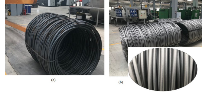
Şekil 6. Kangal görünümü a) Kumlama öncesi, b) Kumlama sonrası.
