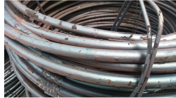
Şekil 1. Kangal yüzeyindeki pas ve tufaller.
