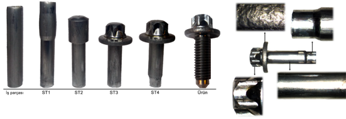
Şekil 12 Üretim denemesi sonucunda meydana gelen malzeme akışları.
