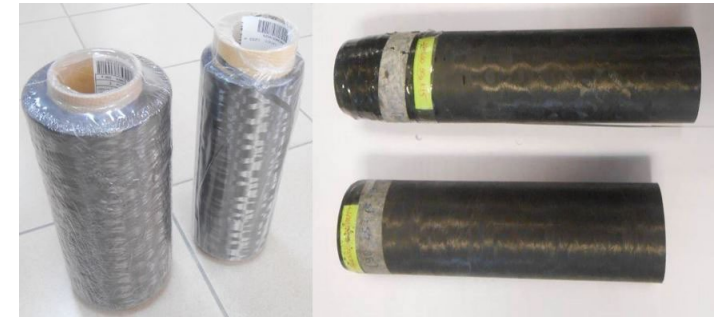
Şekil 4. UMS 40 ve IMS 65 Karbon Fiber Rulolar ile [90/±45/±15/90]n Oryantasyonunda Üretilen Kompozit Tüpler.
