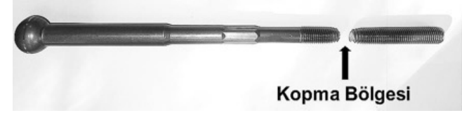
Şekil 14. Çekme testi yapılmış rot mili.
