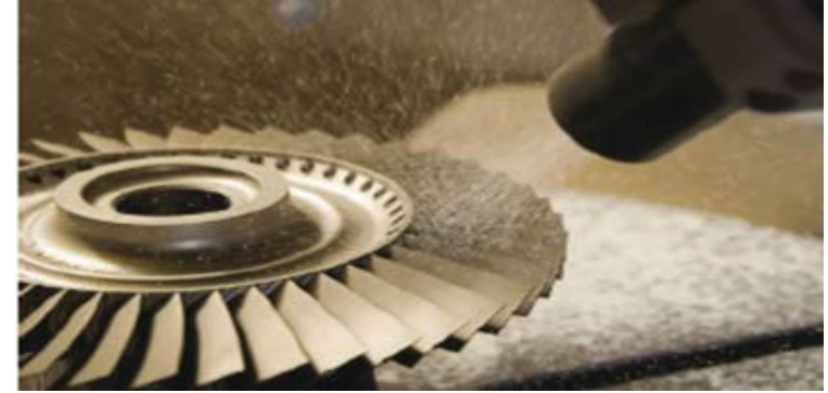
Şekil 1. Türbin kanatçıklarının bilya püskürtme ile yüzey işlemine tabi tutulması.
