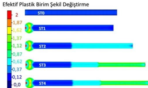
Şekil 7. İstasyonlara Göre Efektif Plastik Birim Şekil Değiştirme Dağılımı.
