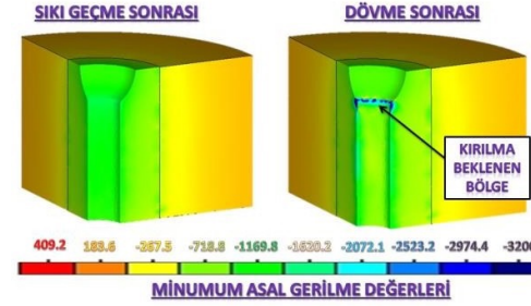
Şekil 11. Kalıplarda oluşan Minimum Asal Gerilmeler.
