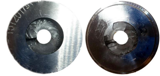
Şekil 3. Hasarlı sabit kalıplar.
