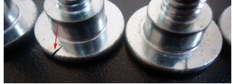
Şekil 1. Bağlantı elemanlarında kafa formunda meydana gelen çatlak hatası
